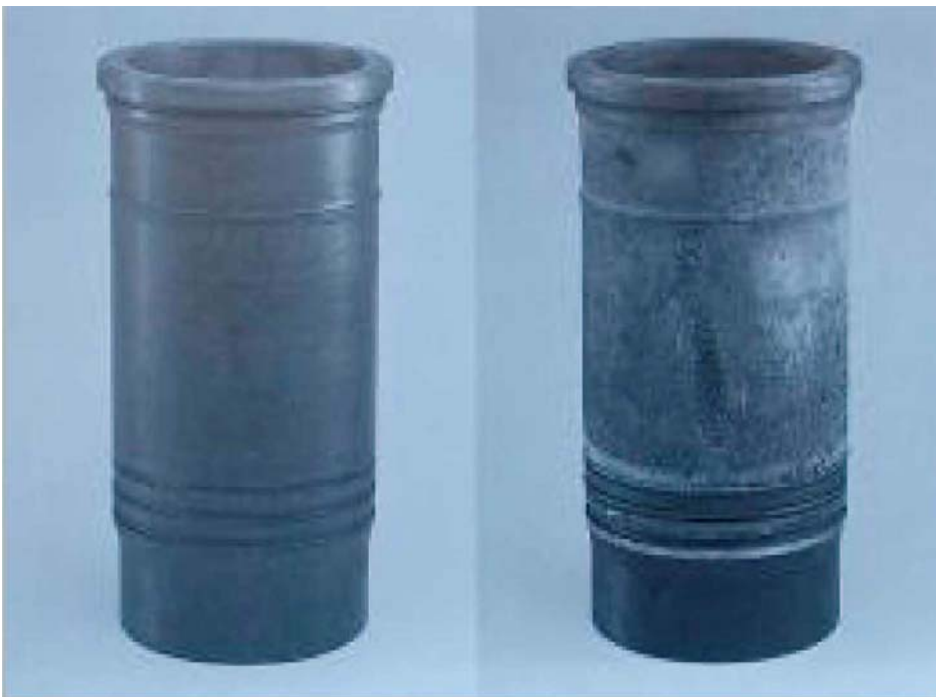
Zylinderrohr aus einem Motor mit Korrosionsschutz
